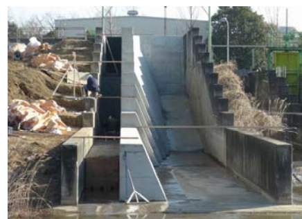
写真-2 高落差実験水路(縮尺 1/2)
